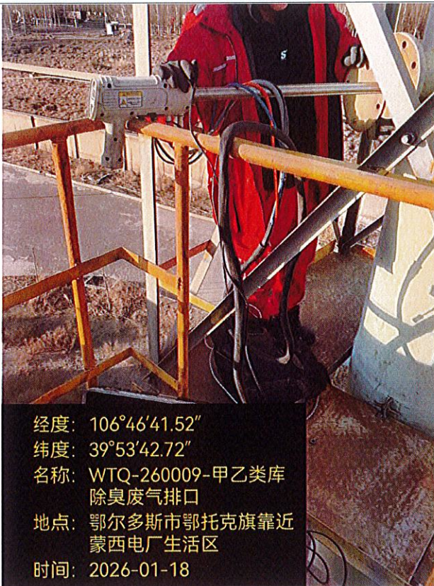
甲乙类库除臭废气排放口 采样
